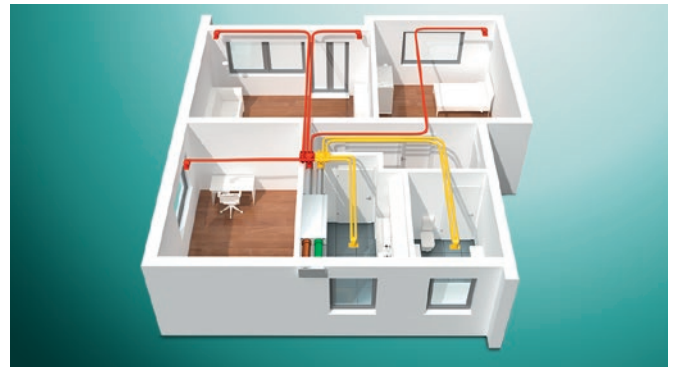
recoVAIR 150 mennyezeti készülék dupla homlokzati-kivezetővel és a földémben vezetett kerekcsatorna-rendszerrel
