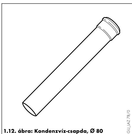
1.12. ábra: Kondenzvíz-csapda, Ø 80
