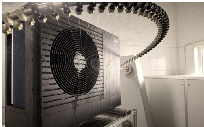
Vízugaras teszt az extrém esőzések elleni védelemhez
