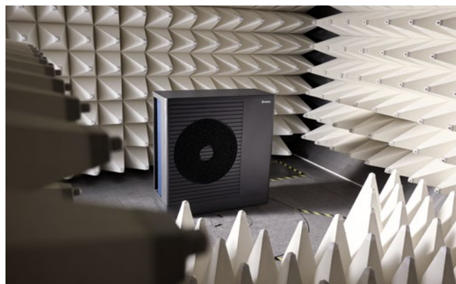
EMC-teszt az elektromágneses sugárzás kizárására
